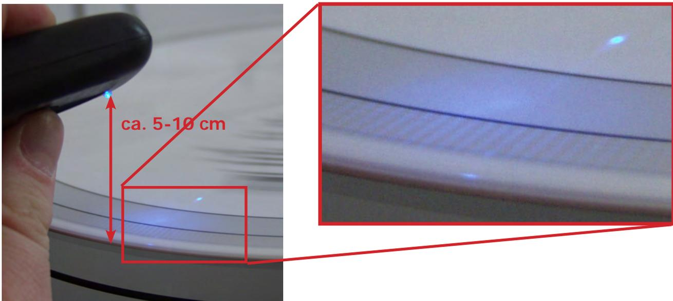
**Abb. 1:** Abstand zwischen *Speed Light* and *Stroboscope Testrecord*
